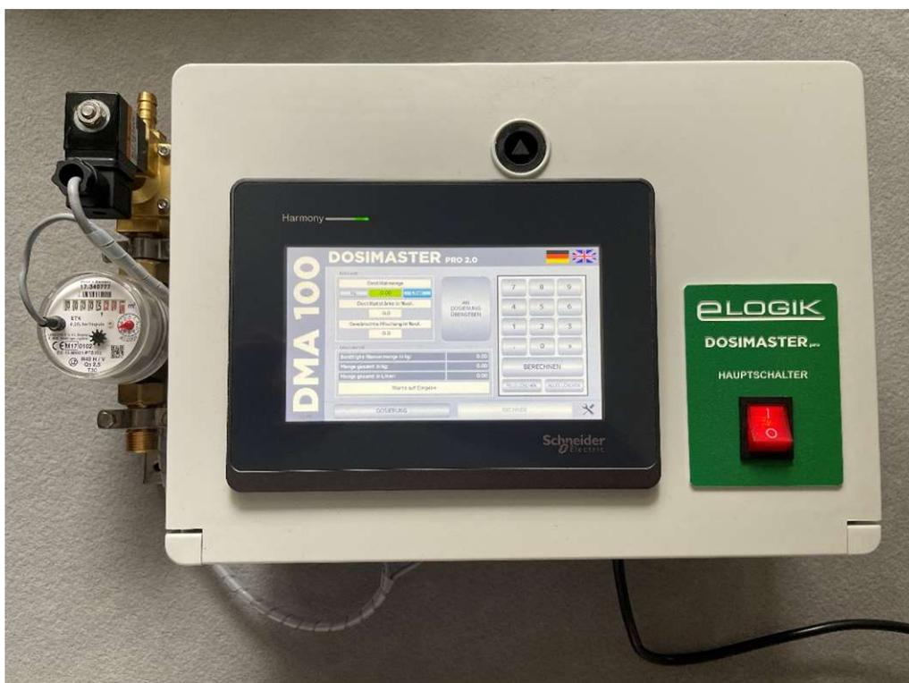
Automatische Dosierung zum Herabsetzen von Alkohol mit der hinterlegten amtlichen Alkoholtabelle.
